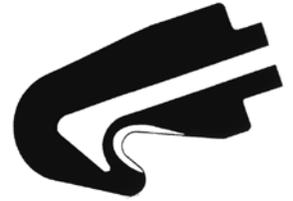
En forma de gancho. Se engancha en el material y se desliza a lo largo de la base de corte. La no. T02S0 se desplaza a un ángulo de 90°.
